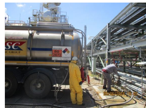
ภาพที่ 3-25 การติดฉลากสารเคมี และสัญลักษณ์บนรถขนส่ง
